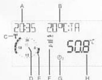
Del temperatūros jutiklių paklaidos yra galimas +/- 2K(°C) temperatūrų parodymų nuokrypis. Esant staigiamis temperatūrų pasikeitimams, atsiranda laikini temperatūrų nuokrypiai dėl skirtingų jutiklių charakteristikų laiko intervaluose.
